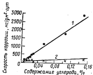
Рис. 18. Зависимость скорости коррозии в 0,12 н. HCl (25° С) от содержания углерода в стали [201]:
